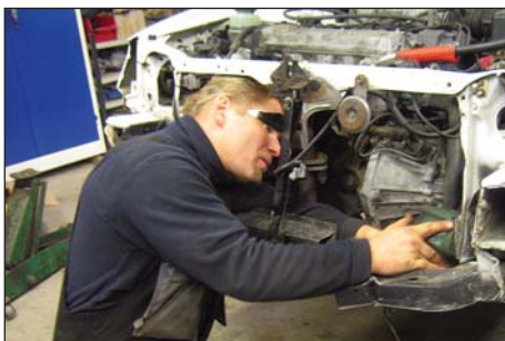
Bytting av frontbjelke på min datters bil.
