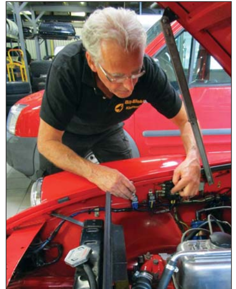
Jan Klemmetsby i Bil-Elektro i Tønsberg monterte releer og sikring mellom hovedlys og bryter.
