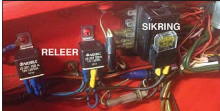
Jan Klemmetsby i Bil-Elektro i Tønsberg monterte releer og sikring mellom hovedlys og bryter.
