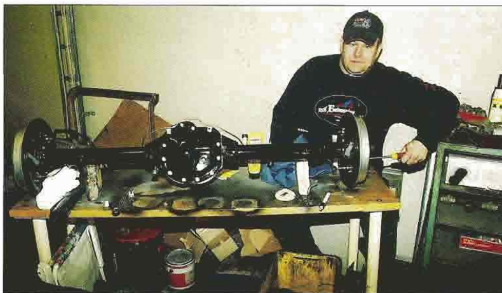
Bakakselen med nye bremsetromler, bremserør og det hele gir et godt inntrykk.
