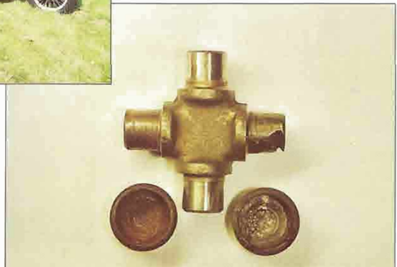
Slik ser et mellomaksel kryss ut etter mer enn 30 års bruk uten vedlikehold! Merkelig at det ikke har tatt kvelden for lenge siden.
