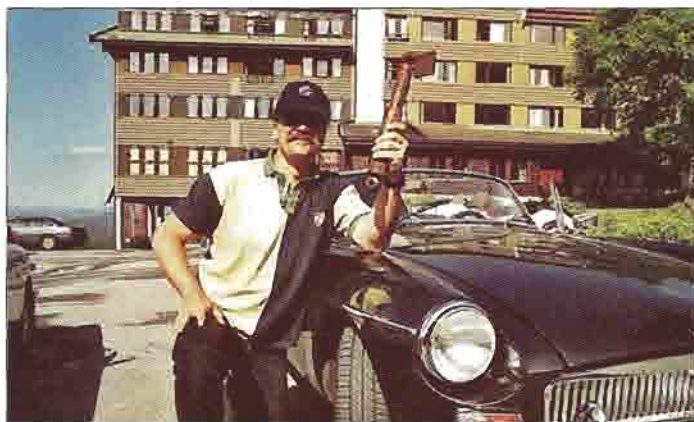
Per-Henrik Nilsen hadde bare et valg - skru av den defekte, uoriginale støtdemperen. Ettersom MGB'en har stiv bakaksel gikk det greit å kjøre med bare en støtdemper bak.
